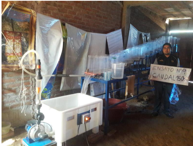
Figura N° 124. Ensayo N° 9 en Modelo Físico La Cascada con Caudal al 150%.
