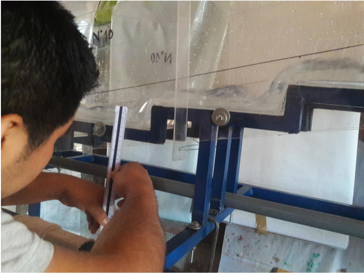
Figura N° 119. Medida de Tirantes con Caudal al 100%.
