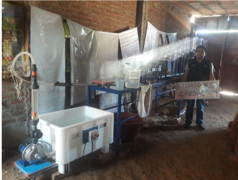
Figura N° 116. Ensayo N° 5 en Modelo Físico La Cascada con Caudal al 90%.
