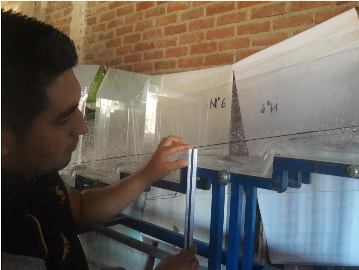
Figura N° 117. Medida de Tirantes con Caudal al 90%.
