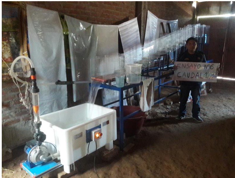
Figura N° 118. Ensayo N° 6 en Modelo Físico La Cascada con Caudal al 100%.
