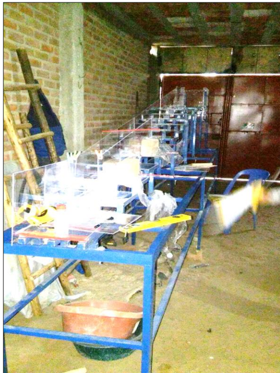
Figura N° 101. Montaje y alineación de la pared intermedia del canal.
