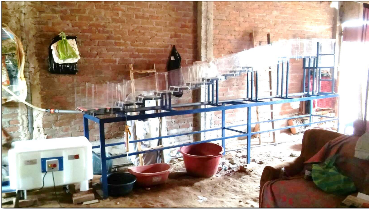
Figura N° 104. Ensayos del Modelo físico de La Cascada.
