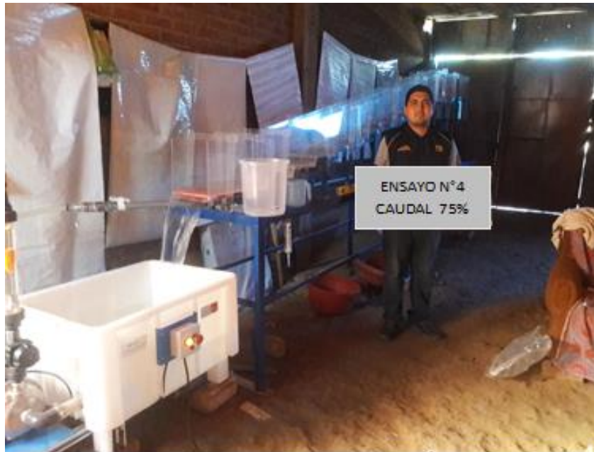
Figura N° 114. Ensayo N° 4 en Modelo Físico La Cascada con Caudal al 75%.
