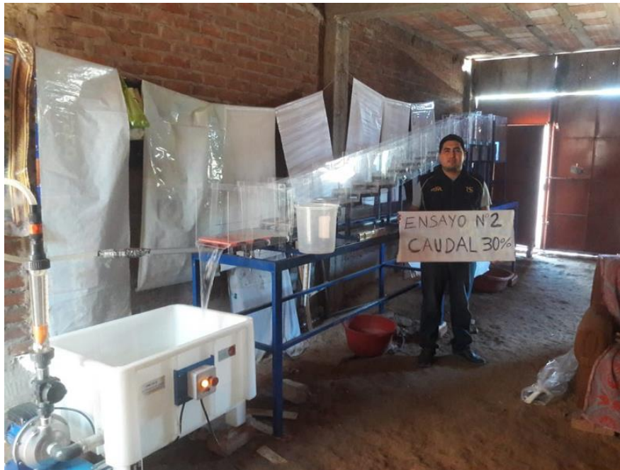
Figura N° 110. Ensayo N° 2 en Modelo Físico La Cascada con Caudal al 30%.
