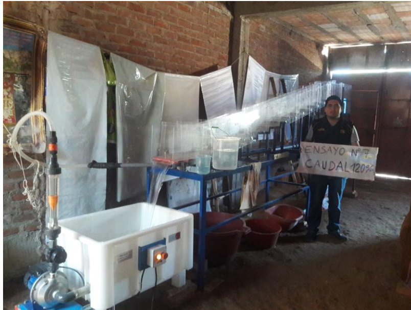
Figura N° 120. Ensayo N° 7 en Modelo Físico La Cascada con Caudal al 120%.
