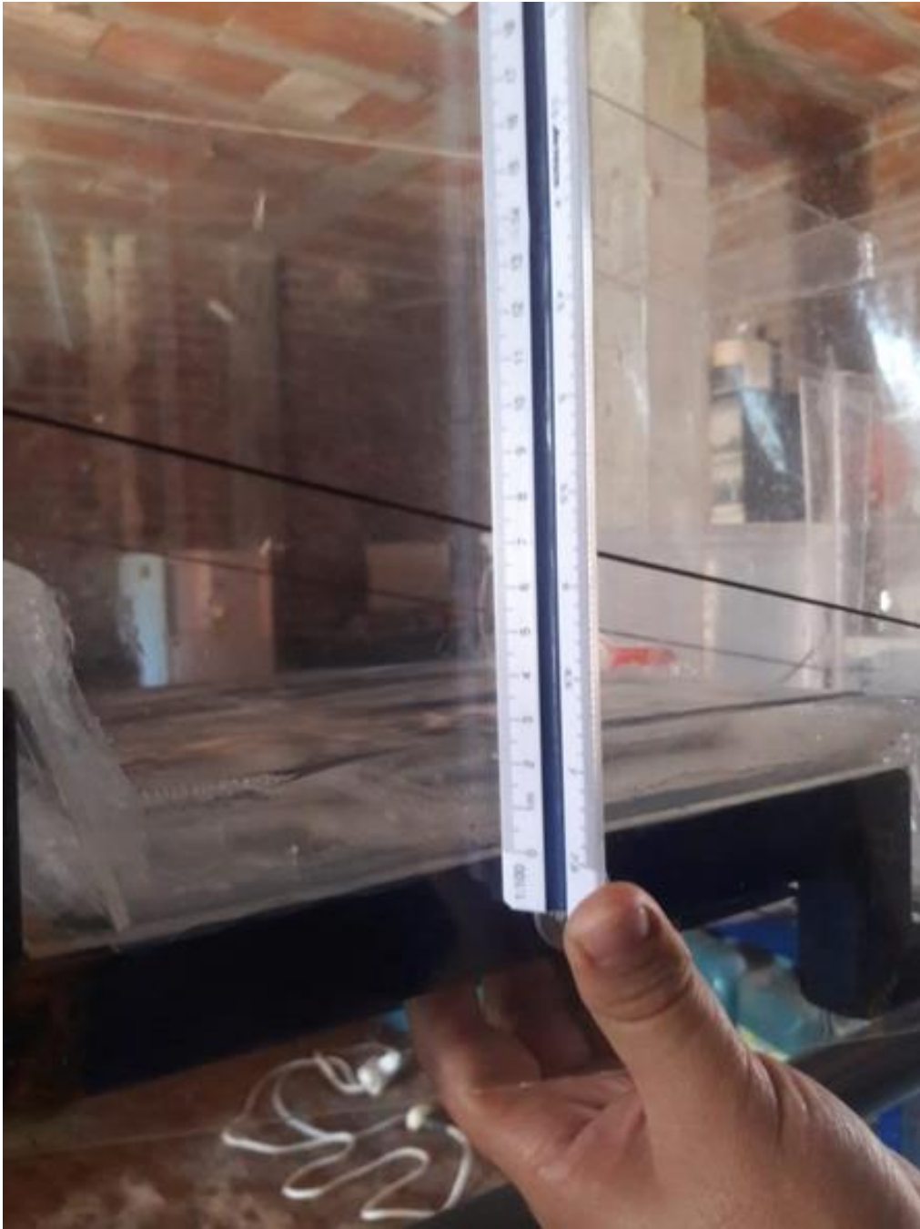
Figura N° 109. Medida de Tirantes con Caudal al 15%.
