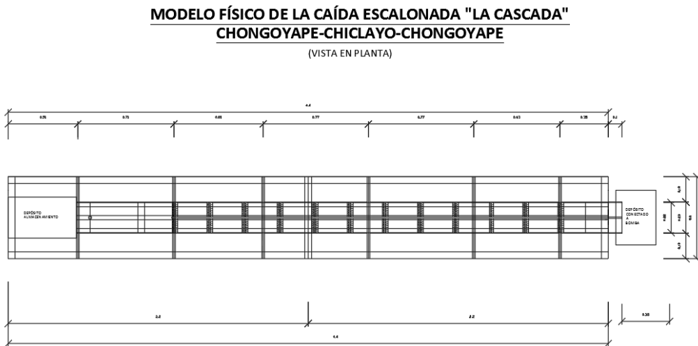
Figura N° 56. Plano de Vista en Planta del Diseño del Modelo Físico La Cascada.
