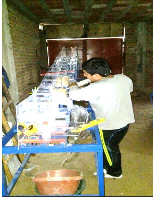
Figura N° 100. Fijado de piezas de acrílico.
