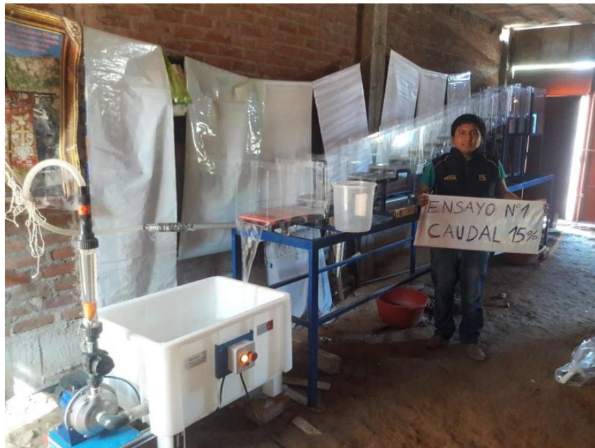
Figura N° 108. Ensayo N° 1 en Modelo Físico La Cascada con Caudal al 15%.
