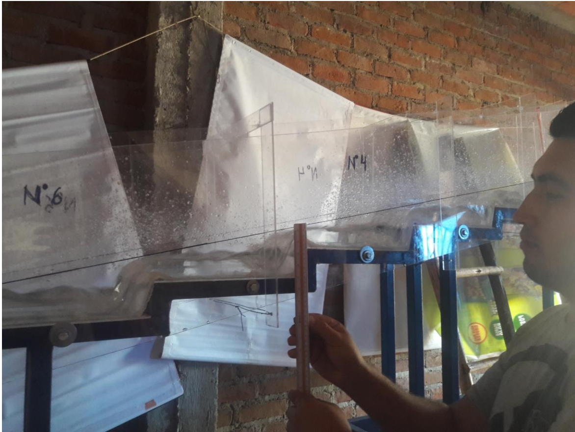
Figura N° 121. Medida de Tirantes con Caudal al 120%.
