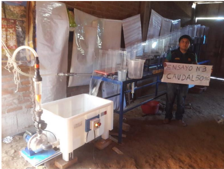
Figura N° 112. Ensayo N° 3 en Modelo Físico La Cascada con Caudal al 50%.
