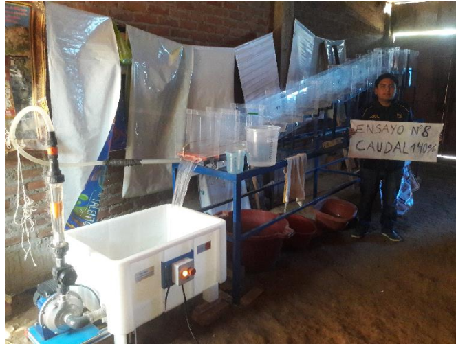
Figura N° 122. Ensayo N° 8 en Modelo Físico La Cascada con Caudal al 140%.
