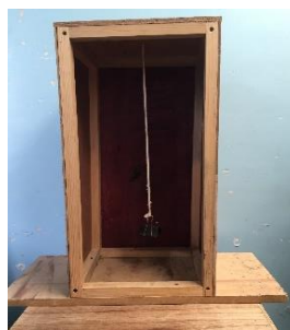
Figura. 6: El modelo consiste en un ortoedro de madera, en cuya cara superior estará sujeto un lazo con una pinza para sujetar a la rata por la cola (30*30*50 cm).
