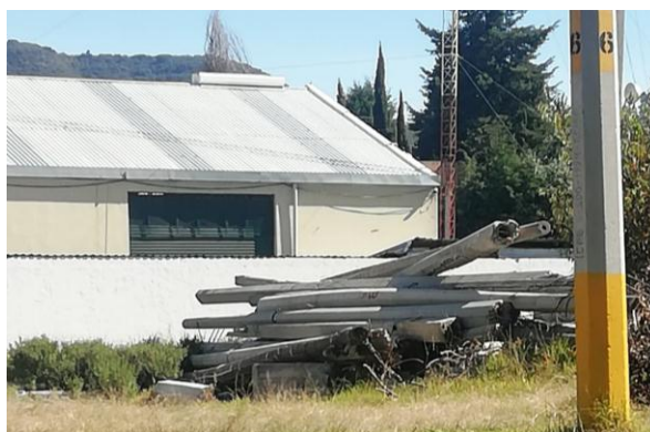
Imagen 13. Postes PCR-13-600 en fin de uso en almacén de Zona Tlaxcala (Fuente: Elaboración propia).
