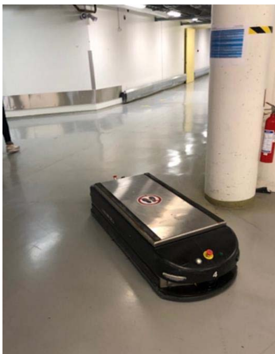
Figur 40. TransCar LTC2 Automated Guided Vehicle System (AGV) fra Swisslog med og uten last.
