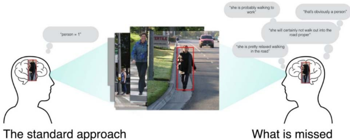
Figur 45, Utfordringer med tolkning av en fotgjengers intensjon i utvikling av kunstig intelligens (AI) for selvkjørende kjøretøy. Kilde NVIDIA
