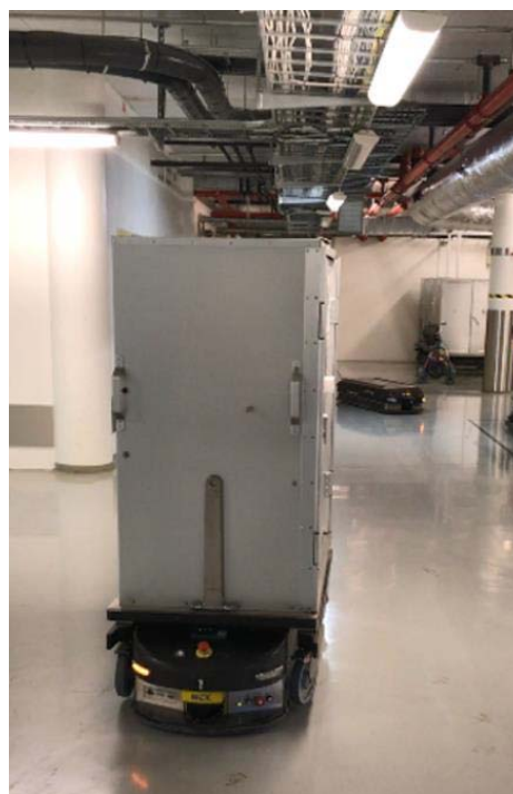
Figur 40. TransCar LTC2 Automated Guided Vehicle System (AGV) fra Swisslog med og uten last.
