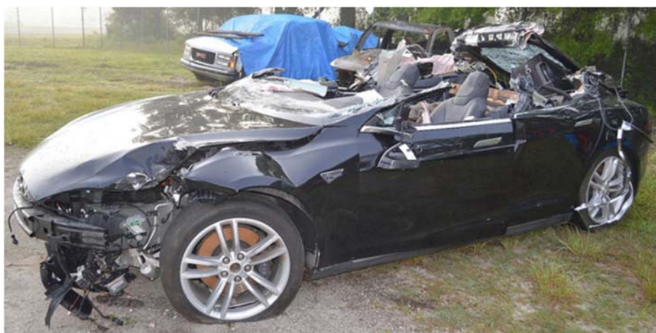
Figur 33. Bilde av Tesla S modell etter dødsulykken i Florida 2016, der taket ble flerret av i kollisjon med semitrailer.
