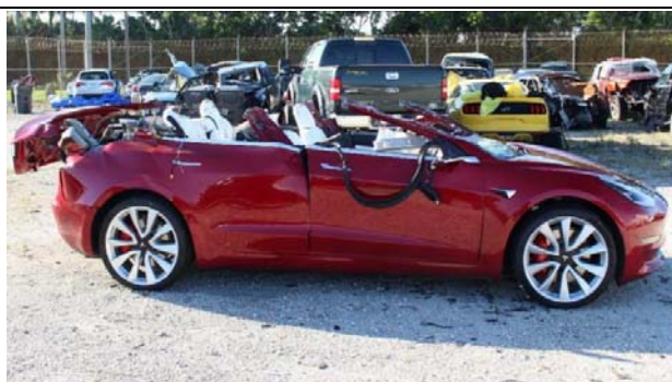
Figur 34. Bilde av Tesla modell 3 etter kollisjon med semitrailer i Florida som gjorde omfattende skade på taket. Foto National Transportation Safety Board
