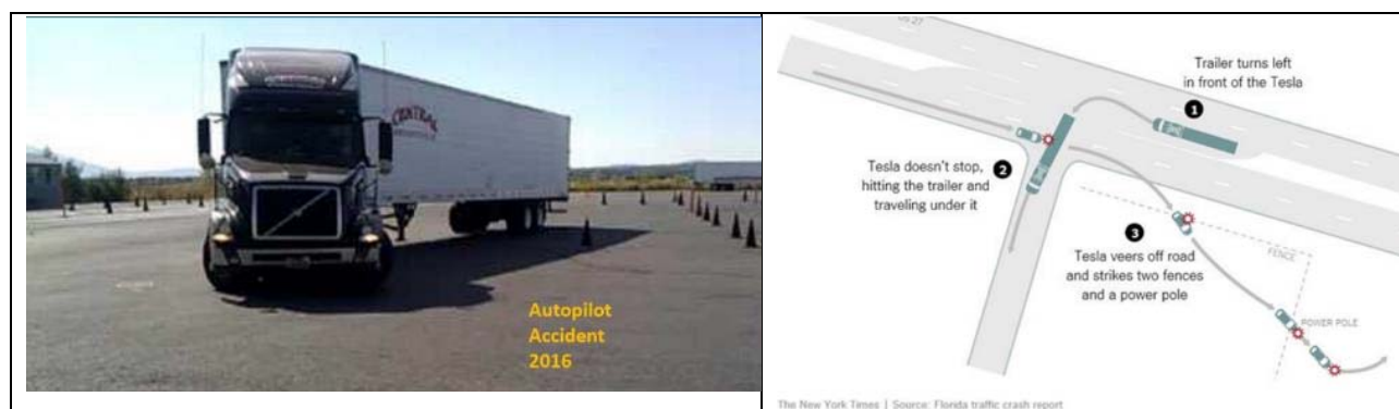
Figur 32. Bilde av den type semitrailer (t.v.) som var involvert i dødsulykken med Tesla på autopilot i Florida 2016, Illustrasjon av ulykkesituasjonen (t.h.). Kilde New York times.
