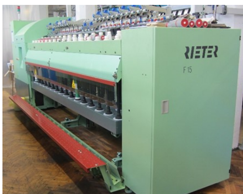
Abbildung 3-14: Flyer F15 (links) und Prinzipskizze der Garnverspinnung mittels Flyer (rechts)
