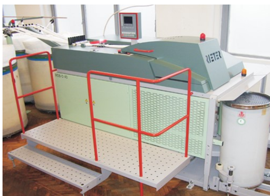
Abbildung 3-7: Eingesetzte Kurzstapel-Strecke RSB-D 40 V2 (links) und Prinzipskizze einer Nadelstabstrecke [97] (rechts)
