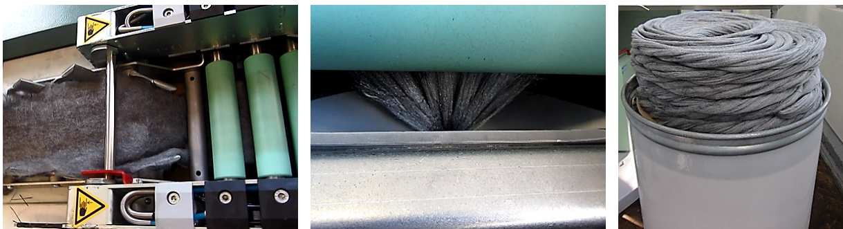
Abbildung 5-18: Zuführung des Krempelbands zum Streckwerk (links), Einzug des verstreckten Bands in die Vliesführungsdüse (Mitte) und in einer Kanne abgelegtes Streckenband (rechts)
