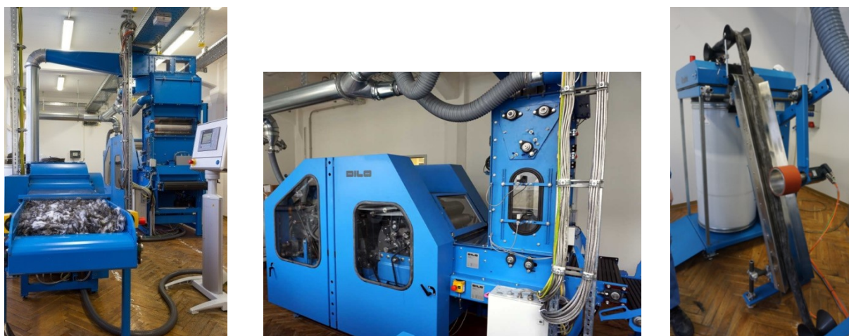
Abbildung 5-28: Am ITM installierte Spezialkrepelanlage; Links im Vordergrund: Faseröffner und Krepelspeiser; Mitte: Spezialkrepel; Rechts: Bandtransporteinrichtung und Kannenstock
