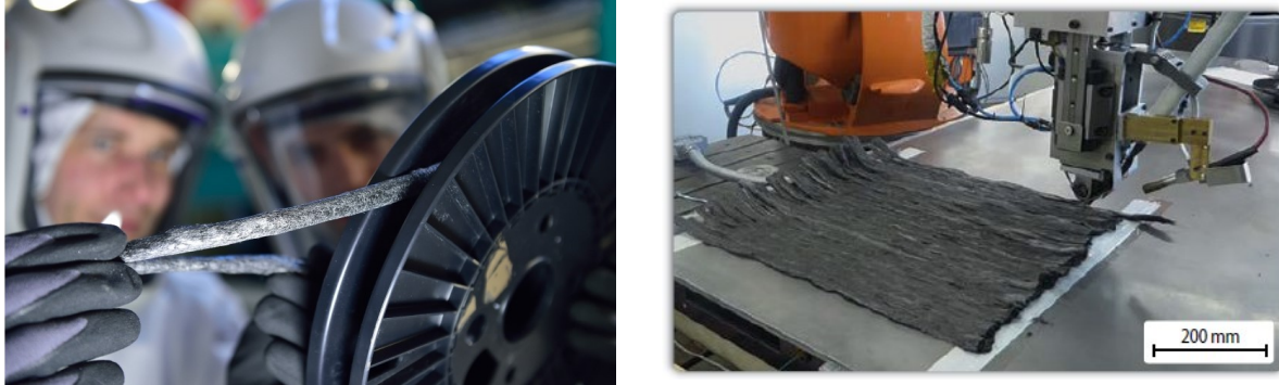
Abbildung 2-4: Bandstruktur aus 100 % rCF (links) [78] und mittels Tapelegen abgelegte rCF-Bandstrukturen (rechts) [79]
