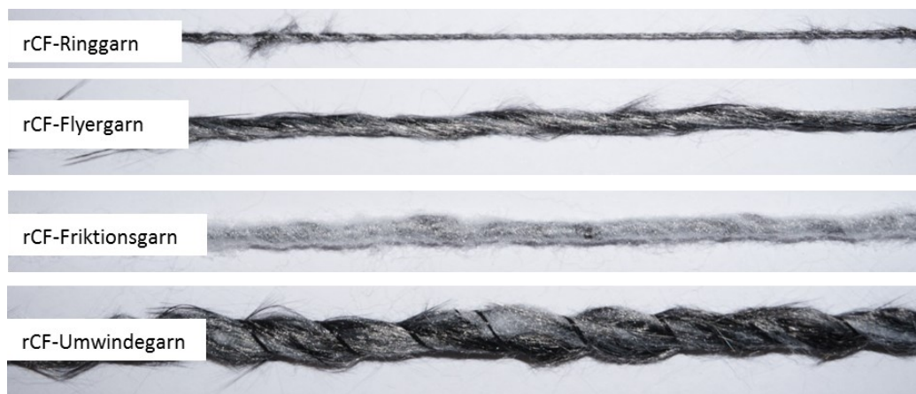
Abbildung 3-13: Umgesetzte rCF-Garnkonstruktionen auf der Basis unterschiedlicher Spinnverfahren
