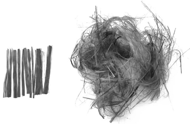
Abbildung 5-5: Ungeöffnete (links) und vorgeöffnete (rechts) rCF mit jeweils gleicher Fasermenge
