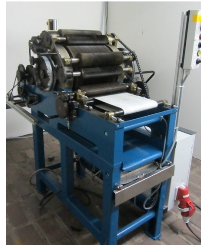
Abbildung 3-2: Schematische Darstellung (links) und reale Abbildung (rechts) der eingesetzten Laborkrempel
