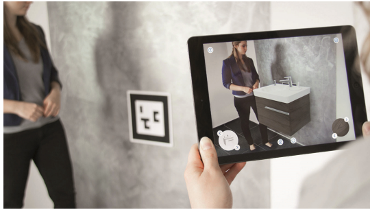
Abb. 2.4: Auf einem Tablet können virtuelle, dreidimensionale Inhalte, wie ein Waschbecken, passend im Raum platziert werden [Hur18].
