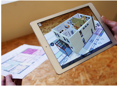
Abb. 1.3: Ein AR-Anwendung auf einem Tablet zeigt das passende Gebäudemodell zu einem Grundriss [Aug18].
