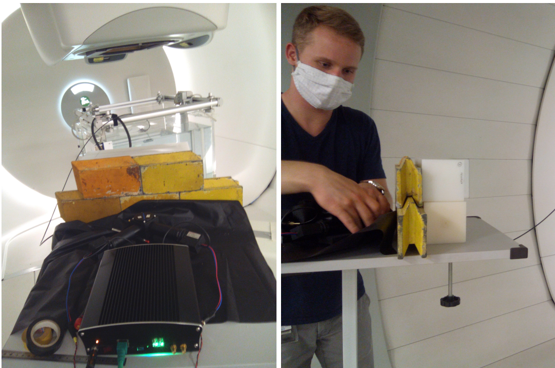
Abbildung A.3.4: Experimenteller Aufbau bei den finalen Messungen an der UPTD. Das Messsystem wurde im Vergleich zu Abbildung 3.3.1 nicht verändert. Jedoch ist die zusätzlich installierte Abschirmung vor dem Messsystem zu erkennen, welche den Einfluss der Streustrahlung reduzieren soll.
