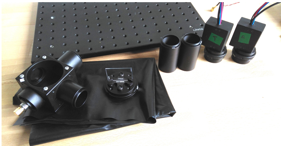
Abbildung A.3.2: Die Einzelteile des optomechanischen Aufbaus: Würfelförmig, Deckel des Würfels mit dichroitischen Strahlteiler, Tuben, Einzelphotonensensoren (v. links).
