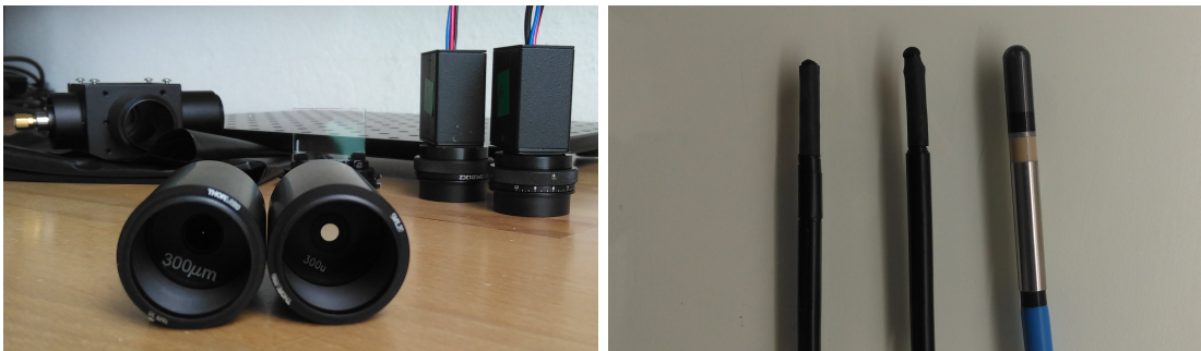
Abbildung A.3.3: Links: Blick in die Tuben. Darin sind die eingesetzten Blenden mit 300\ \mu\text{m} Durchmesser zu sehen. Rechts: Die Enden der verwendeten Sonden im Vergleich zu der Ionisationskammer (Semiflex, PTW-Freiburg). Von links: BeO-Sonde, Blind-Sonde, Semiflex.
