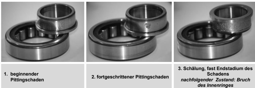
Abbildung 3: Entwicklungsstadien von Pittingschäden
