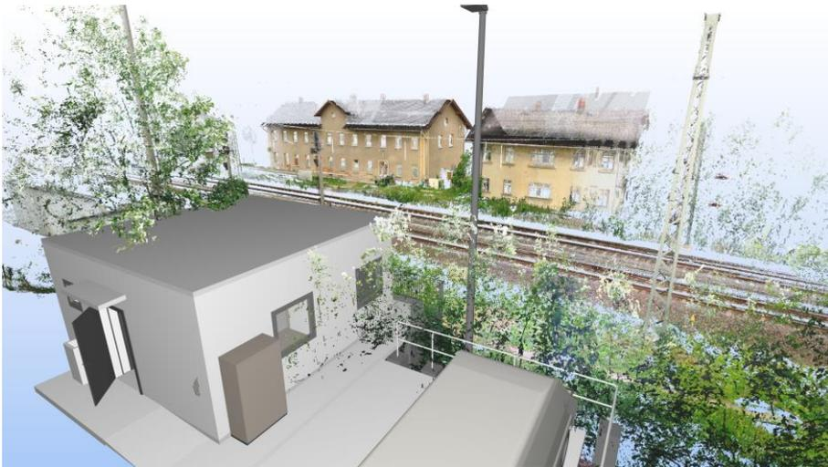
Abbildung 4: 3D-Gesamtmodell des geplanten Modulgebäudes in seiner Umgebung
