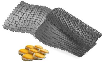
Abbildung 12: Rendering von drei unterschiedlichen Schuppenelementen (überlappende Geometrie)
