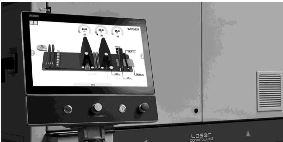
Abbildung 1: Exemplarische Anlage mit dem Siemens SIMATIC HMI Comfort PRO Panel (Kranert et al. 2018, S. 292).
