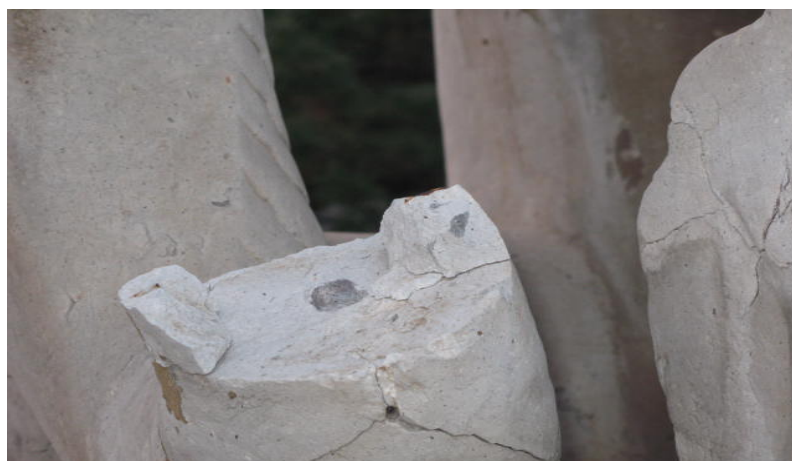
图26 石象鼻，分解粉化引起石头边缘缺失
