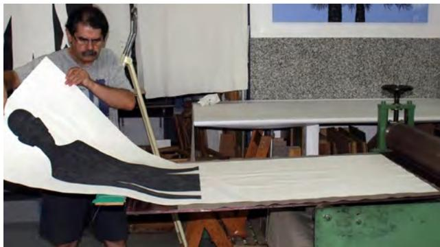
Luego se cubre todo con la mantilla de fieltro y se procede al desplazamiento de la platina para efectuar la impresión.
