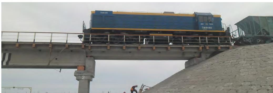
Рис. 3. Фотография установки сцепа «локомотив-вагон» на пролётное строение 0–1 (нагрузка С1) (сделана авторами).
