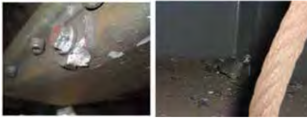
Рис. 1. Повреждения корпуса вагона от ударов частиц щебня [6].
