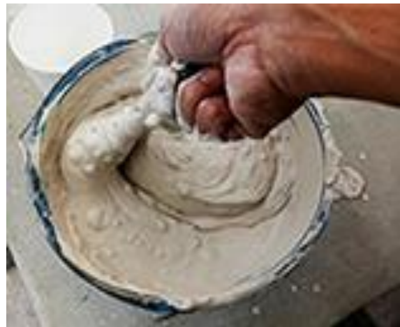
1.b) Membuat adonan gypsum dan kalsit untuk memplester adonan menjadi bentuk oval (dokumen pribadi 2020)
