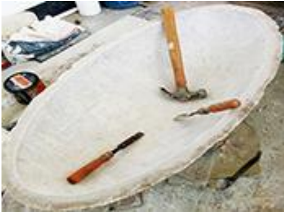
2.d) Merapihkan sisi dalam cetakan untuk proses pengerjaan tahap berikutnya (dokumen pribadi, 2020).
