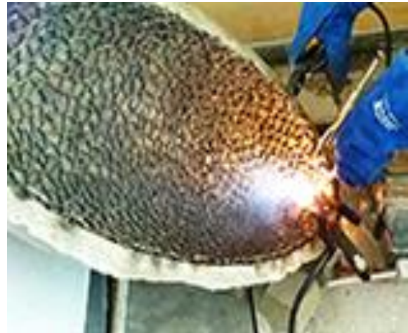
3.c) Proses pengelasan pada bagian tepi cetakan oval (dokumen pribadi 2020).
