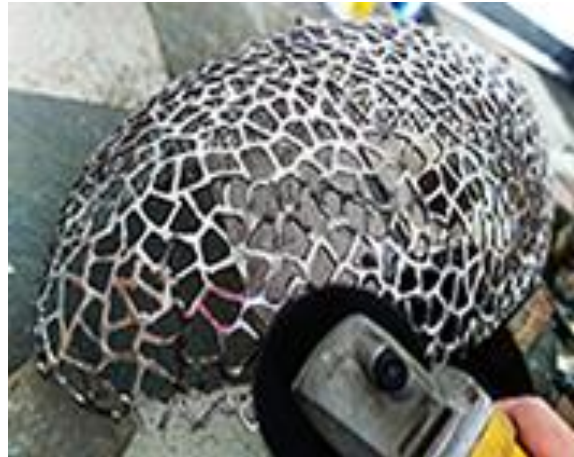
4.2.d) Memoles permukaan oval dengan langsol dan mata gerinda kain jeans poles (dokumen pribadi, 2020).
