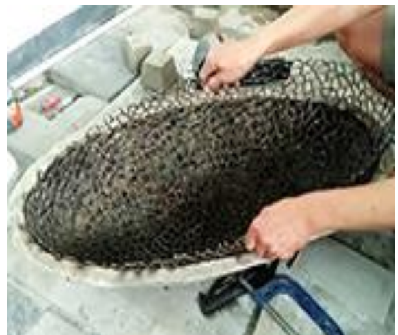
3.d) Mengeluarkan hasil las dari cetakan untuk lanjut ke tahap selanjutnya (dokumen pribadi 2020).
