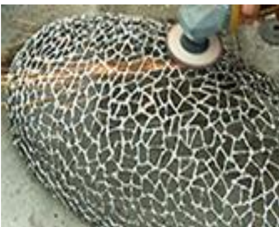
4.2.c) Memapras permukaan oval dengan mata gerinda asah dan mata gerinda amplas susun (dokumen pribadi, 2020).
