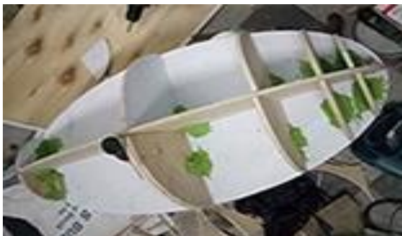
1.a) Konstruksi dari bahan multiplek, sebagai panduan bentuk oval (dokumen pribadi 2020)
