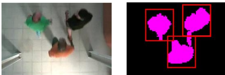
Ilustración 06. Esquema del funcionamiento de la cámara cenital InOutCounter
