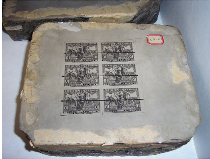
Ilustración 4.1. Piedra litográfica utilizada para imprimir el billete de 10 centavos portugués (1914-18), Museu das Comunicações.
