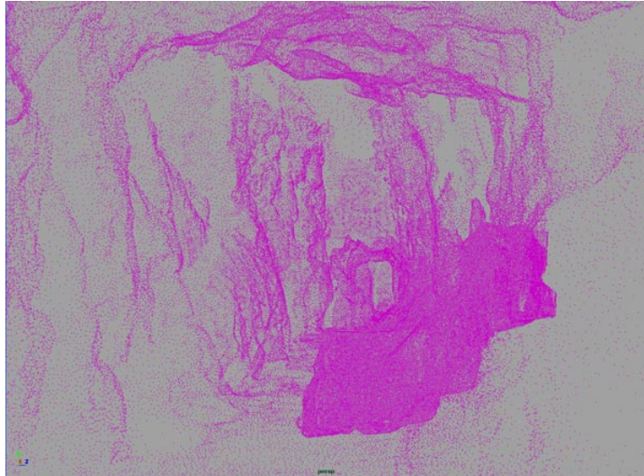
Ilustración 3. Representación de una porción de cueva mediante nube de puntos filtrada.
