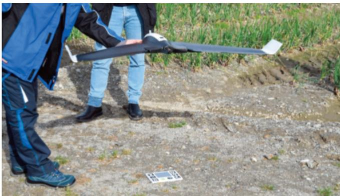
Fig. 3 - Il drone ad ala fissa Parrot Disco-Pro AG utilizzato per il rilevamento multispettrale. In foto, la fase di pre-calibrazione effettuata prima dell'esecuzione del volo utilizzando un pannello a riflettanza nota.
