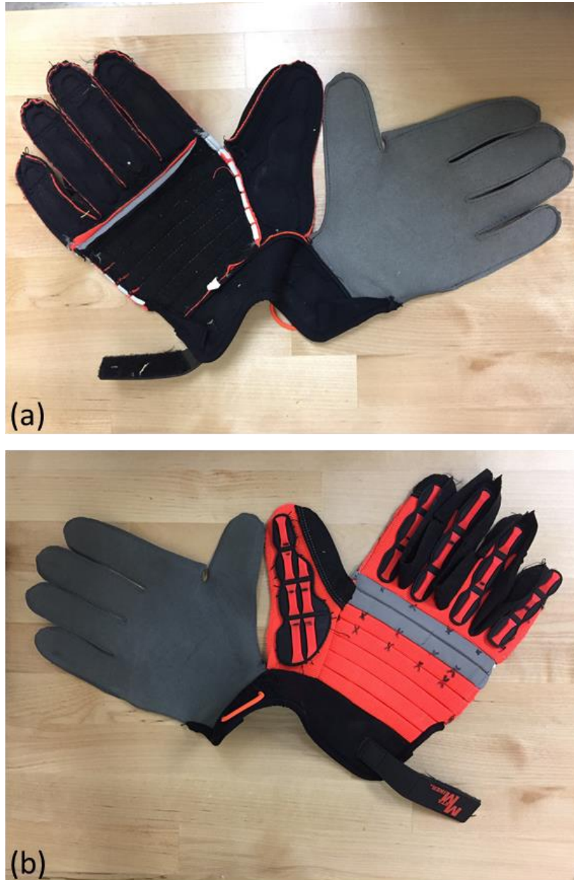
Figure A.D- 4: Disassembled glove G1. (a) Posterior & anterior (inner). (b) Posterior & anterior (outer).
