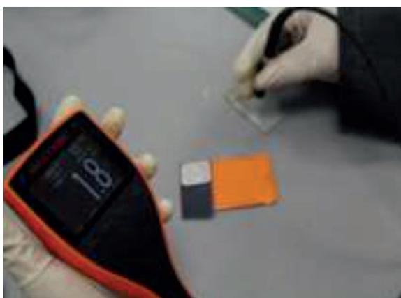
**Figura 10.** Equipo para medición de espesores Elcometer.**Microscopia electrónica de barrido (MEB).**
