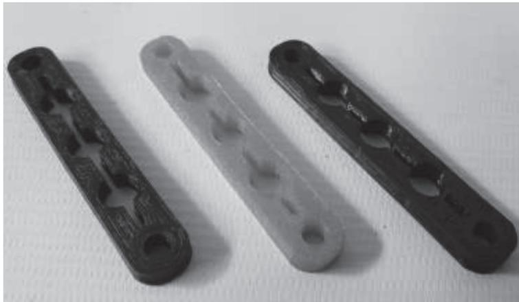
**Figura 5.** Porta electrodos (porta ánodos y porta cátodo).
