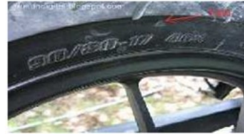
Gambar 5. Ukuran Ban dan indikator keausan ban
