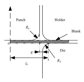
Fig. 6. L-bending test initial setup [16].
