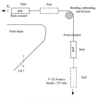
Fig. 9. Schematic of Draw-bend test [10].
