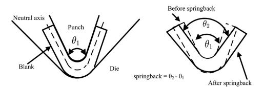
Fig. 5. V-bending test schematic [24].
