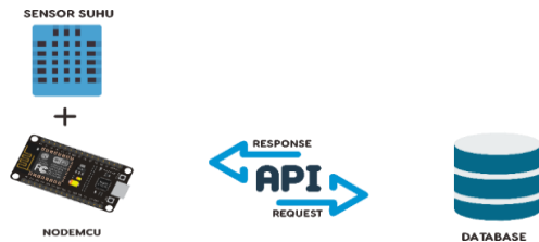
Gambar 4. Rancangan proses komunikasi klien server REST.
