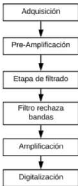
Gráfico 4-3. Diagrama de bloques para la adquisición y lectura de señales EMG mediante electrodos.
