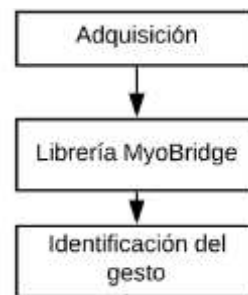
Gráfico 5-3. Diagrama de bloques para la adquisición y lectura de señales EMG mediante brazalete.
