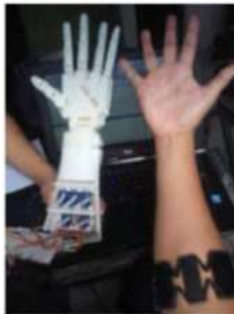
Figura 20-3. Sistema de control de un modelo de prótesis mediante el brazalete Myo.
