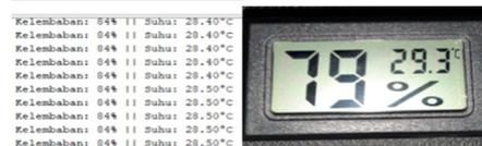
Gambar 12. Pengujian Sensor DHT11
