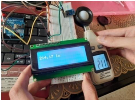
**Gambar 13. Pengujian Sensor BH1750**
