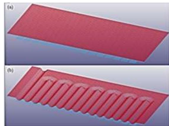
Gambar 4. Hasil *Meshing* Software ANSYS LS-DYNA 18.1 (a) Kondisi Sebelum Pembebanan, (b) Setelah Pembebanan
