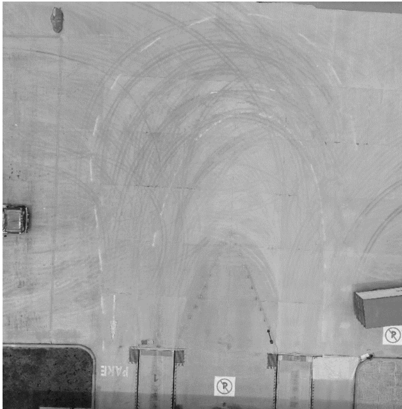
Figura 2. Trayectoria de giro tractocamión C3S3
