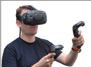
Abb. 5: HTC Vive Head Mounted Display mit zwei eingebundenen Controllern für manuelle Interaktion (Bild: Thies Pfeiffer)
