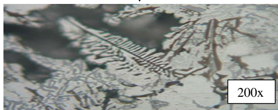
Gambar 3. Struktur mikro material piston pandangan B lokasi 2
