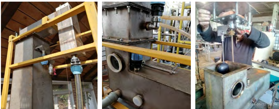
Рис. 3. Зовнішній вигляд фільтрувального блоку АСОВ: а – контролер подачі води на фільтр та промивки фільтра з поплавком зриву вакууму головного клапана; б – прийомна ємність промивної води з важелем зриву вакууму; в – комбінований мембранний клапан промивки фільтра з контр-поплавком
