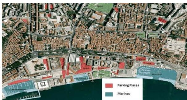
**Figura 28:** Il porto ed i parcheggi individuati a Setúbal che rientrano nell'area potenzialmente inondata dallo scenario di pericolosità di maremoto (HIDROMOD).
