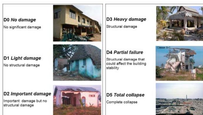
**Figura 16:** Danno strutturale agli edifici in accordo con la scala di danno sviluppata da Leone et al. (2006)
