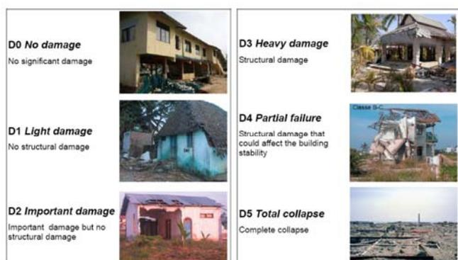
**Figura 16:** Exemplos de danos estruturais em edifícios, de acordo com a escala proposta na Tabela 6.
