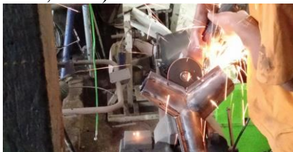
Gambar 3. Proses Pembuatan Cetakan Tetrapod (Dok, 2019)
