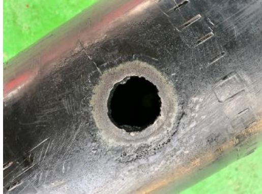
Gambar 4. Simulasi lubang kebocoran pada Manifold Hydrostatic Test
