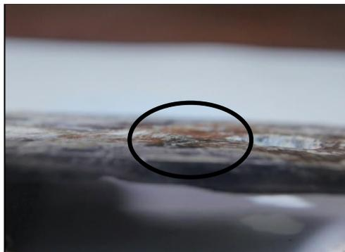
Gambar 5. *Swelling* pada spesimen yang di redam pada air laut selama 21 hari
