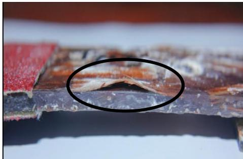
Gambar 4. *Debonding* pada spesimen yang di redam pada air laut
