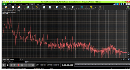
Gambar 7. Spektrum bunyi hasil FFT sasando elektrik dawai ke-18
