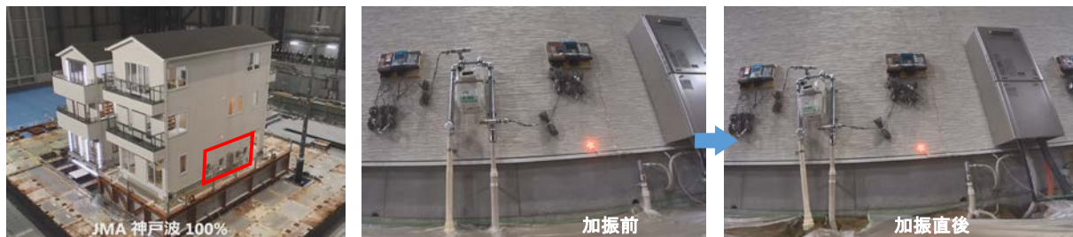
(3) B 棟における、べた基礎の移動によるガス管の変形状況
