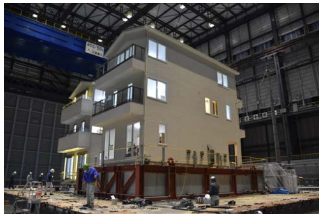
図 14 実物木造住宅を対象とした E-ディフェンス実験
