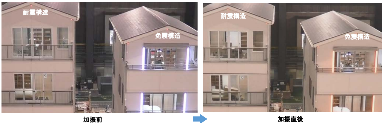
(1) 加振直後の B 棟（耐震構造、左）、A 棟（免震構造、右）の家具の転倒状況
