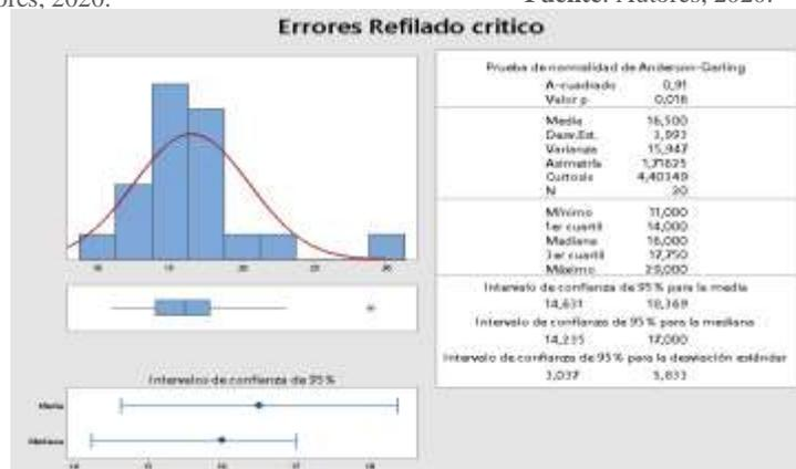
*Ilustración 24. Errores Refilado crítico*
