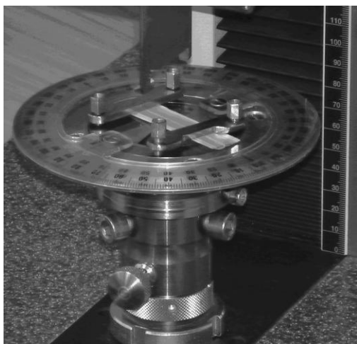
1.att. Iekārta ciršanas griešanas pētījumiem
