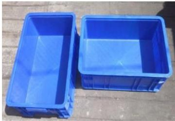
Gambar 1. Reaktor Uji.
