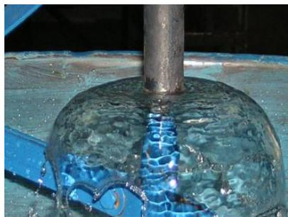
Gambar 5. Proses pendinginan pada alat uji *jominy*
