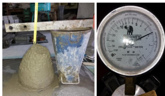
Slika 3. 18 a) Merenje sleganja, b) merenje sadržaja uvučenog vazduha
