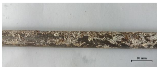
Slika 5. 6 Korozija armaturne šipke izvađene iz neisprskalih NAC uzoraka nakon 168 dana izloženosti 2% CO 2
