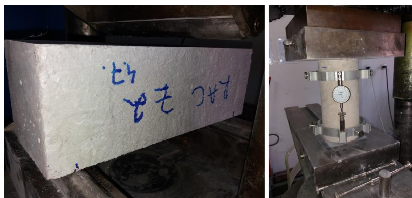
Slika 3. 21 Ispitivanje a) čvrstoće na zatezanje, b) modula elastičnosti
