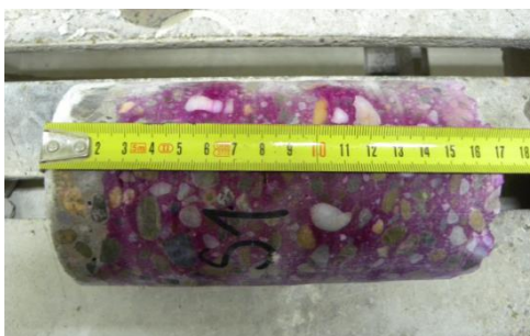
Slika 3. 6 Dubina karbonatizacije betona iz stuba nadvožnjaka nakon 40 godina
