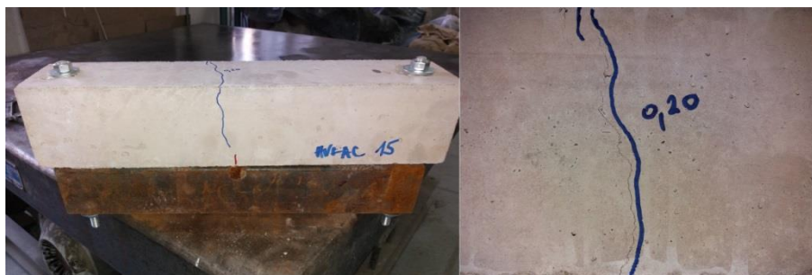
Slika 4. 31 Test uzoraka sa prslinom i obeležavanje prsline
