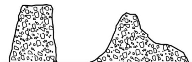
Slika 3. 19 Forma početnog sleganja a) „pravo“ b) „smičuće“
