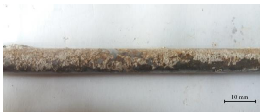
Slika 5. 8 Korozija armaturne šipke izvađene iz neisprskalih HVFAC uzoraka nakon 84 dana izloženosti 2% CO 2
