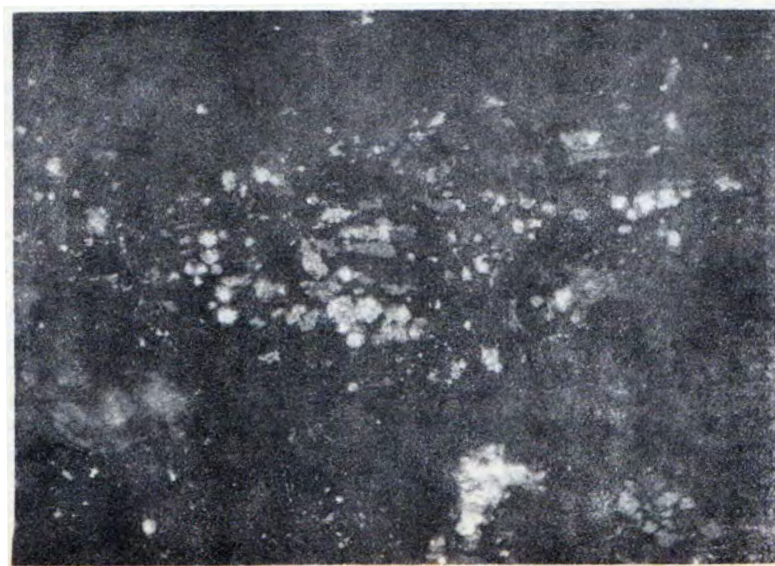
Fig. 5. Concreciones de pirita esfericas (blanca) en "turba" de manglar, fijadas a residuos vegetales descompuestos (gris). Corte pulimentado, 250 x.
