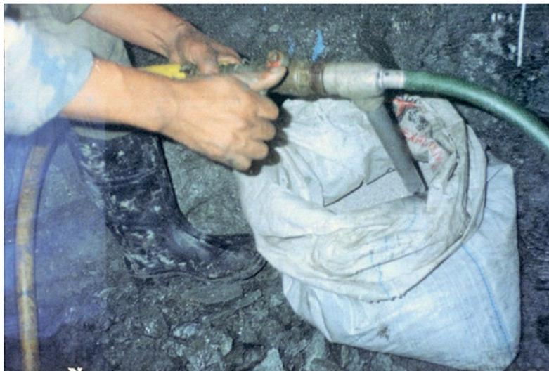
Figura 1. Equipo para el carguío de ANFO dentro de los taladros aplicando el principio de Venturi
