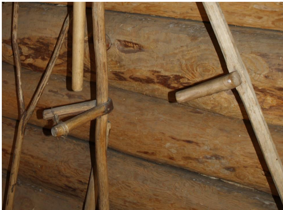
Foto 3. Typy rączki na kosisku na obszarze ziemi łukowskiej – z prawej strony typ zachodni ( ro n czka ), z lewej wschodni ( korzystka )
