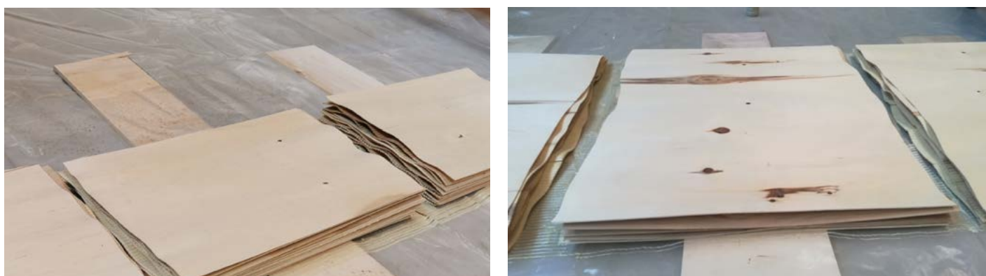
CHAPA DE ALTA CALIDAD USADA PARA LOS PANELES Q1 CHAPA DE BAJA CALIDAD PARA LOS PANELES Q2
