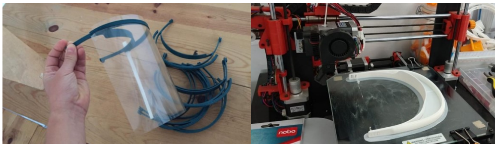
Figura 5: Viseiras de proteção fabricadas em impressora 3D (FabLab Guarda)
