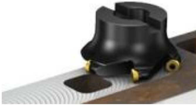
Figura 3 – Ferramenta porta-pastilhas com pastilhas redondas e marcas de maquinação (adaptado de [19]).
