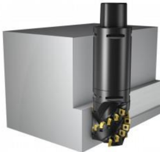
Figura 9 – Fresagem de ombro profundo feito por ferramenta porta-pastilhas de passo repetido [24].
